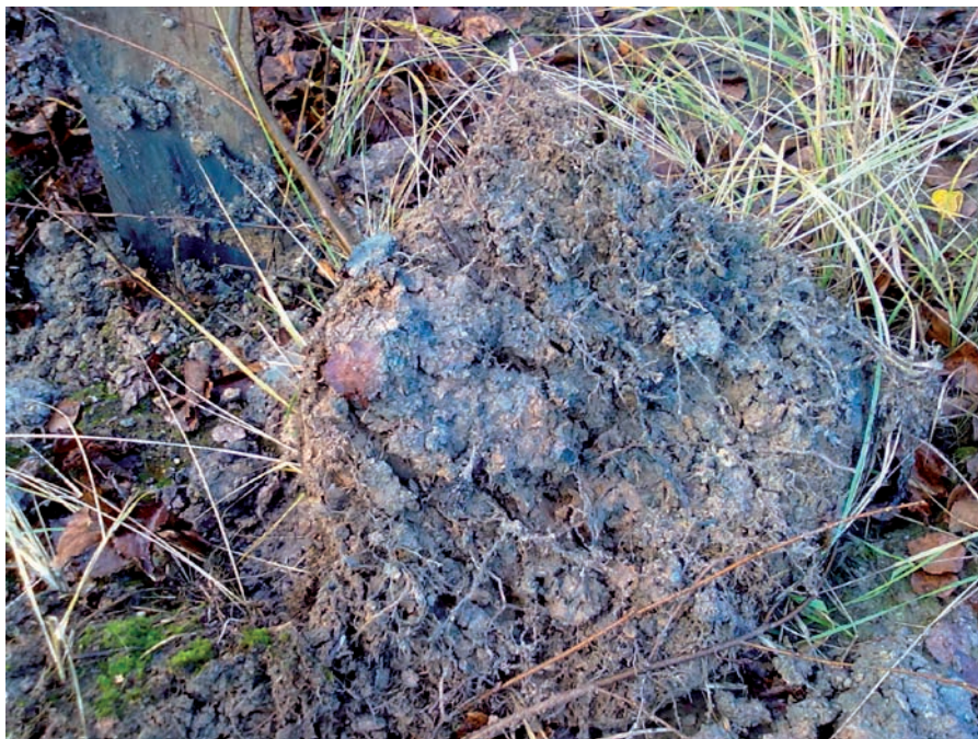
Het uit steenkool geproduceerde gas bevatte het zeer toxische blauwzuur (HCN). Om het gas te reinigen, werd het blauwzuur chemisch gebonden op ijzeroxiden.
